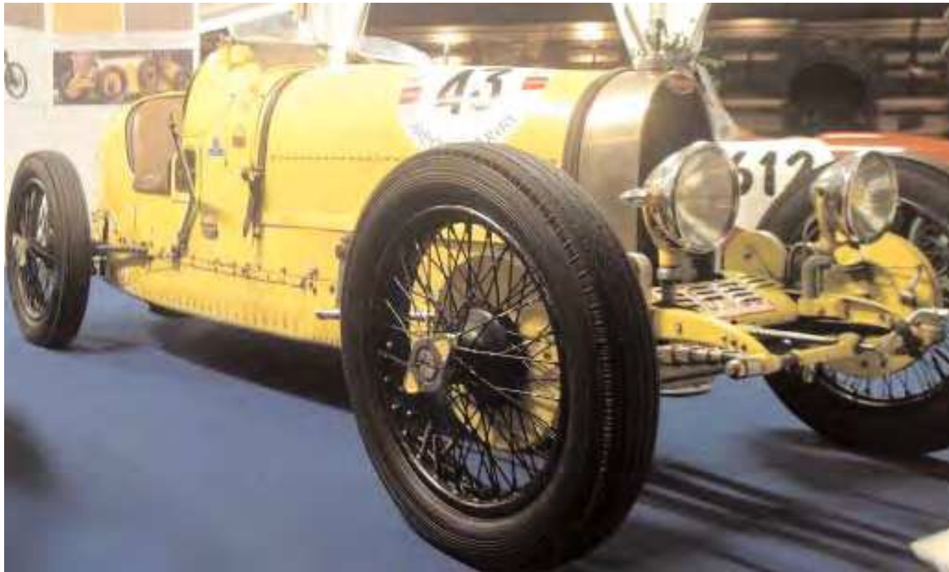
— Bugatti T35A 1991 cm 3 , 80CV, 8 cilindri, del 1925
