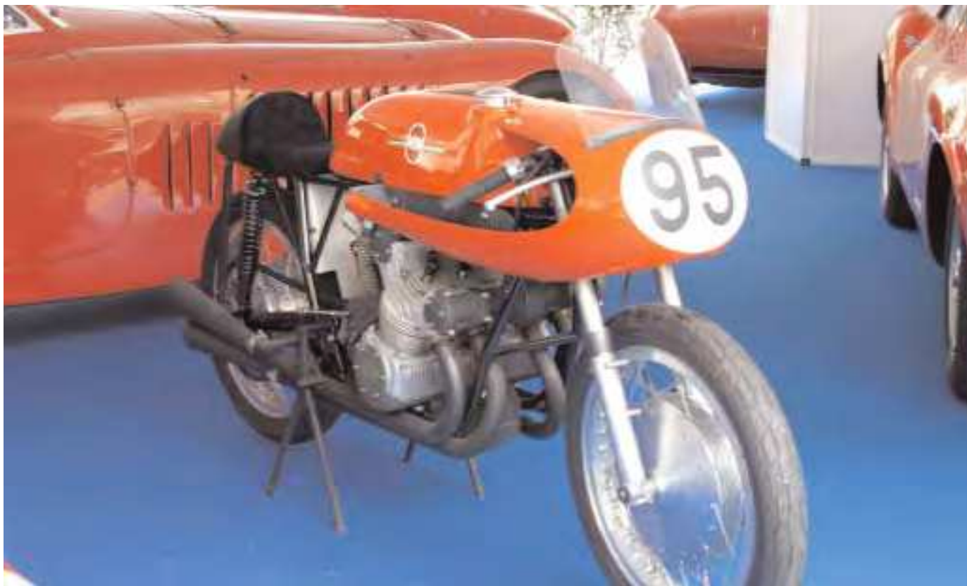
Gilera 500 500 cm 3 , 65 CV, a 4 cilindri inclinati di 30°.
