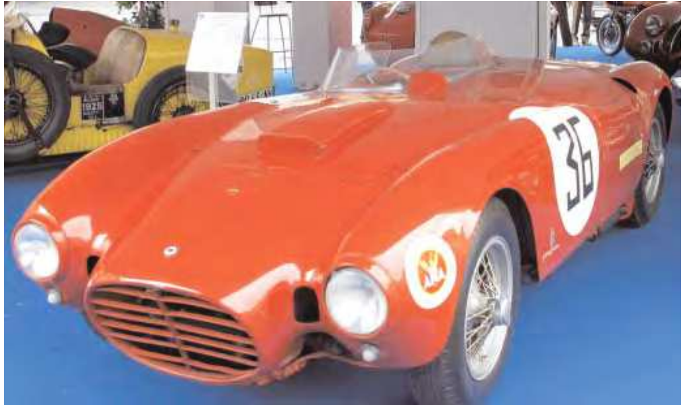
Lancia D 24 Sport, 6 cilindri a V di 60°, 3284 cm 3 , 265 CV, del 1953
